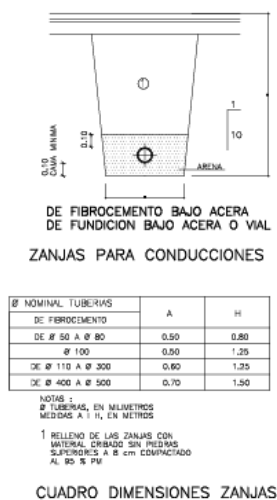
Figura 6. Sección zanjas y dimensiones de las instalaciones de abastecimiento. Fuente: Plano I-02 Proyecto de infraestructuras soterradas permanentes para el evento Carreras de Caballos en playa de Sanlúcar. Avenida de las Piletas, S/N, Sanlúcar de Bda (Cádiz).
