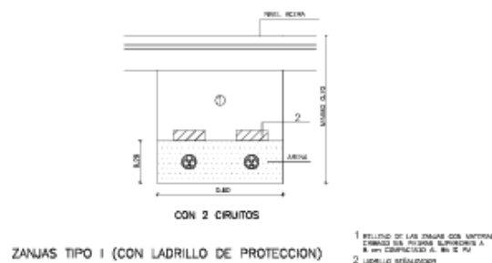
Figura 8 Sección zanjas de las instalaciones de electricidad. Red de tomas. Fuente: Plano I-03 Proyecto de infraestructuras soterradas permanentes para el evento Carreras de Caballos en playa de Sanlúcar. Avenida de las Piletas, S/N, Sanlúcar de Bda (Cádiz).
