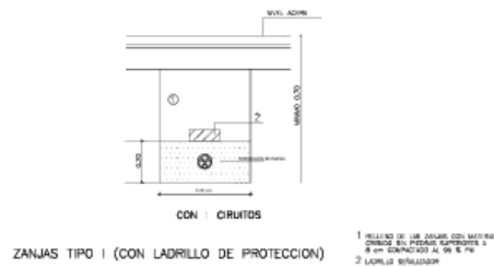
Figura 10 Sección zanjas de las instalaciones de electricidad. Red de alumbrado. Fuente: Plano I-04 Proyecto de infraestructuras soterradas permanentes para el evento Carreras de Caballos en playa de Sanlúcar. Avenida de las Piletas, S/N, Sanlúcar de Bda (Cádiz).
